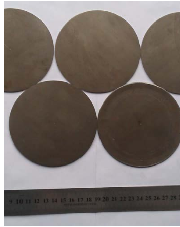
Рис. 11. Вихідні листові заготовки сталі 10
