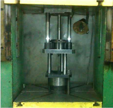
Рис. 10. Штамп для витягування, який встановлений на гідравлічному пресі зусиллям 1,6 МН
